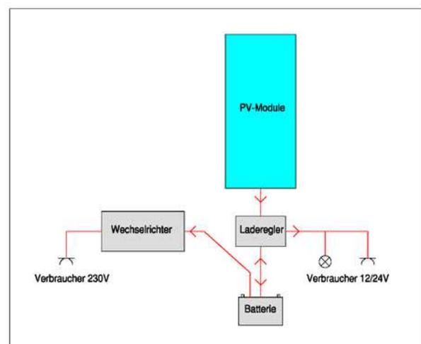
Der mit den Solarmodulen erzeugte Gleichstrom wird in den Batterien gespeichert und bei Bedarf an die Verbraucher abgegeben. Um eine möglichst lange Lebensdauer und hohe Zuverlässigkeit der Anlage zu erreichen, werden spezielle Batterien und geeignete Laderegler verwendet. Durch die Anschaffung äußerst energiesparender Gleichstromverbraucher können die Anlagekosten gesenkt werden.
