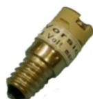
**NV-Adapter E14**Adapter von E14 Gewinde auf G4-GX5,3-GY6,35 12/24V, 1-50W max.
