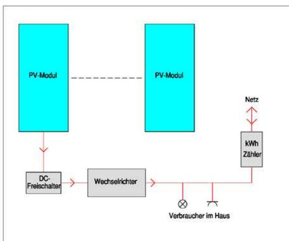
Der mit den Solarmodulen erzeugte Gleichstrom wird mit Hilfe eines Netzwechselrichters auf 230V Wechselstrom umgewandelt und synchronisiert. Der erzeugte Strom wird entweder direkt in das öffentliche Netz eingespeist, oder bei Überschussanlagen bestmöglich in den eigenen Elektrogeräten verbraucht. Dieses System benötigt keine Batterien und ist daher wartungsfrei und sehr zuverlässig. Ein Notstrombetrieb ist jedoch nicht möglich.
